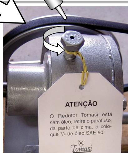
Nos modelos com o acionamento lateral, a churrasqueira é entregue com o conjunto do motor e redutor montado.
