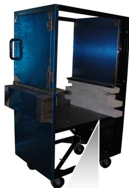
Inicie a colocação dos tijolos a partir da parede traseira do tanque , onde os mesmos já estão colocados.
