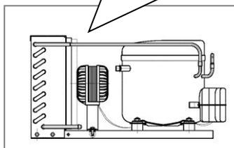
A cada 15 dias deve ser feita uma limpeza no condensador da unidade de refrigeração utilizando escova de nylon macio.
