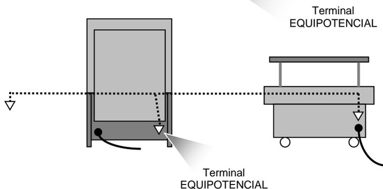
Se este equipamento for instalado próximo a outros, a partir da mesma rede de alimentação elétrica, faça a conexão entre eles pelo terminal equipotencial.
